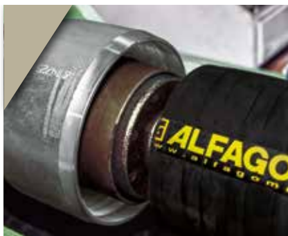
4. Insertion du raccord dans le tuyau
